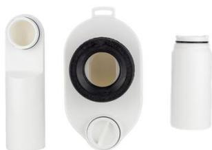
Siphon pour urinoir à encastrer, sortie horizontale ou verticale. Hauteur : 168 mm. Largeur : 96 mm. Raccordement d'entrée :  $\varnothing$  50 mm. Raccordement de sortie :  $\varnothing$  50 mm horizontale ou verticale. Garde d'eau : 50 mm. Profondeur d'encastrement : 73 mm.
