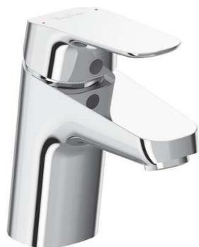
Mitigeur lavabo OKYRIS. Tirette et vidage bonde polypropylène. Bec fixe avec limiteur de débit maxi 5l/min. Cartouche diamètre 38mm CH2. Flexibles d'alimentation PEX 3/8?? 350 mm. Système de fixation rapide EASY-FIX. Hauteur sous aérateur 68 mm. Hauteur totale 133 mm. Projection 101 mm.
