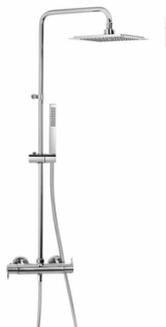
Cartouche Thermostatique  $\varnothing 34$ . Distributeur 2 voies avec fermeture. Débit à 3 bar: 12 l/min en sortie douchette et 10 l/min en sortie douche de tête. Résistent au choc thermique et chimique anti-légionelle. Garantie de 5 ans en robinetterie et 3 ans en compléments.
