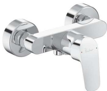
Poignée en métal. Sortie de douche 1/2" par le dessous avec clapet anti-retour intégré. Cartouche diamètre 38 mm avec limiteur de température intégré. Raccords muraux.
