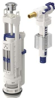
Mécanisme économiseur d'eau double chasse : 3/4L ou 6/9L. Adaptable à tout type de réservoir. Hauteur de la cloche auto-ajustable. Tube de trop-plein réglable en hauteur. Kit d'adaptation pour réservoir avec trou du couvercle de 50 mm. Alimentation latérale, 12 x 17 mamelon en laiton chromé brillant.
