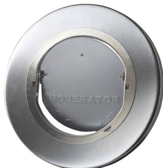
Diamètre de 200 mm à 280 mm. Le Moderator maintient une température des fumées entre 120 et 130°C et une consommation moyenne horaire sur 15h de 0,87kg (au lieu de 1,35kg sans).
