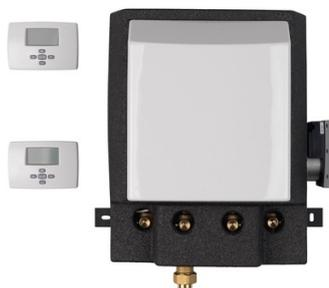
Permet de réguler deux zones dans lesquelles la température des émetteurs est différente. Comprend : 1 circulateur pour la zone radiateur, 1 circulateur pour la zone plancher, 1 sonde extérieure sans fil, 1 vanne mélangeuse, 4 vannes d'arrêt, 1 contrôleur et 2 thermostats d'ambiance sans fil.
