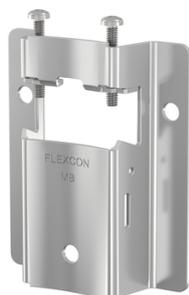
Les supports MB conviennent pour les vases Flexcon / Airfix de 8 à 25 litres et les vases Flexcon P jusqu'à 35 litres (avec bande de serrage). Les supports MB intègrent une large lumière rectangulaire dans laquelle on insère l'anneau de sertissage des vases Flexcon/Airfix. Il suffit ensuite de serrer les deux vis pour fixer le vase.
