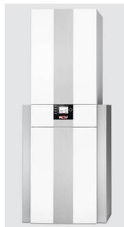
Chaudière sol gaz à condensation avec ballon de 145 L, avec échangeur tubulaire ventouse ou cheminée. Rendement 110 %. Pompe chauffage classe A, pompe de charge ballon et vase d'expansion 10 L intégrés. Habillage de finition inclus. Débit ECS : 21,7 l/min
