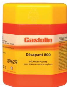
Décapant en poudre constituée d'un mélange de sels complexes de potassium, borates et fluoborates. Il est destiné au brasage du cuivre, laiton et bronze à l'aide d'alliages cupro-phosphores. Poudre rose. A utiliser pour les alliages cupro-phosphores.
