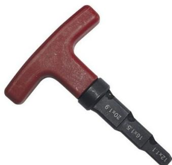
Permet de nettoyer les impuretés après la découpe et d'éviter les fuites. L'ébavureur s'utilise avec les tubes PER de diamètre : 12 x 1,1, 16 x 1,5, 20 x 1,9.
