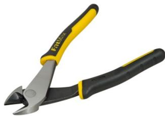
Fabriquée en acier trempé de haute qualité. Double traitement des taillants par introduction. Taillants trempés haute fréquence pour la corde à piano jusqu'à 200 Kg/mm<sup>2</sup>. Finition laquée. Poignée bi-matière FatMax®. Conforme aux normes DIN 5749 et NF E 73-105.
