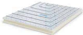
Dalles de dimensions bruts 1200 x 1000 mm, dimensions utiles 1190 x 990 mm, en polyuréthane, revêtues sur chaque face d'un parement composite étanche. Quadrillage au pas de 10 cm sur une face. Bords rainurés bouvetés 4 côtés (sauf dalle 1089874). Certifiée ACERMI Classement SC1a1CH. Tolérance sur épaisseur de la dalle à plus ou moins 5%
