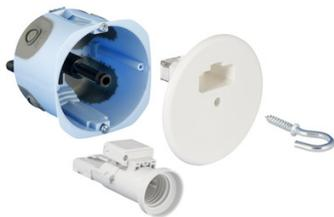
Boîte : Diamètre 67mm profondeur 50mm avec axe centrale solidaire à la boîte - Accepte gaine ICTA D16, D20 et D25.
