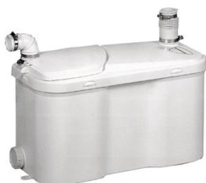
Pompe de relevage haute performance, spécial gros débit (lavabo, douche, baignoire, lave-linge, lave-vaisselle, appareil réfrigérant, chaudière, climatisation, ballon d'eau chaude). Evacuation de vos eaux usées et vannes jusqu'à 10 mètres verticalement ou 100 mètres horizontalement.
