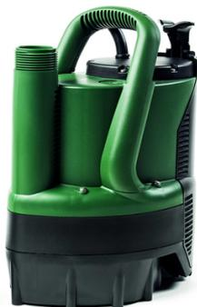
Pompes submersibles d'encombrement très réduit particulièrement adaptées pour puisard étroit (200 mm x 200 mm). Granulométrie : 5 mm. Câble 10 m + fiche normalisée. Commutateur A-M permettant : marche Automatique par flotteur interne. marche Manuelle pour une aspiration jusqu'à 3 mm du sol. Clapet à membrane intégré. En automatique enclenche à 115 mm et coupe à 45 mm du sol. Mono 230 V - 50 Hz - 0,22 kW - 1,3 A.
