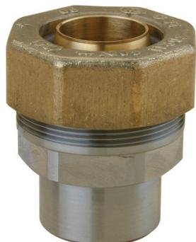
Pression maximale d'utilisation : 5 bar. Serrage au couple avec clef dynamométrique. Certifié NF APE. Conforme NF EN 1555-3.
