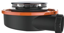
Bonde Flush 44 extra-plate pour receveur de douche D. 90 mm, débit ultra-rapide de 44 l/mn. Capot inox diamètre 115 mm, hauteur 60 mm, sortie horizontale diamètre 40 mm à visser ou à coller. Joint autofix double, pente intégrée 2,5 degré, nettoyage par godet extractible et technologie Flush.
