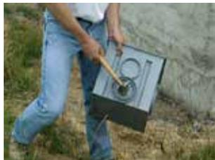
**2** Dégager au marteau les emboîtures à utiliser.
