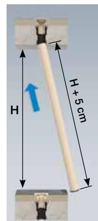
Pour définir la hauteur du tube de descente, mesurer la hauteur (H) entre le sol fini et la sous-face du balcon et rajouter 5 cm.
