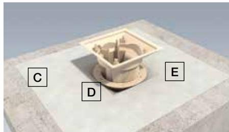
Introduire le corps supérieur (E) équipé de la bague de réglage (D) dans le corps inférieur (B) à travers la natte (C).
