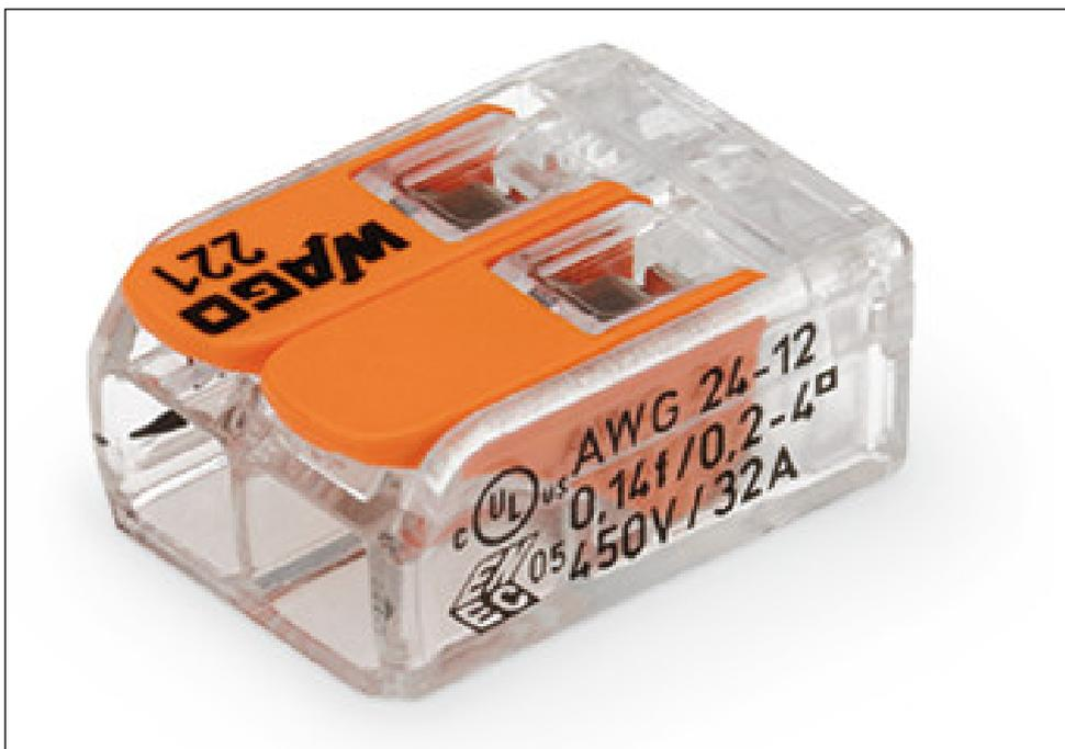
Aperçu d'impression: Bornes pour boîte de dérivation pour tous types de conducteurs COMPACT; Borne pour 2 conducteurs; avec leviers de manipulation; Température ambiante max. 85°C - Numéro d'article: 221-412
