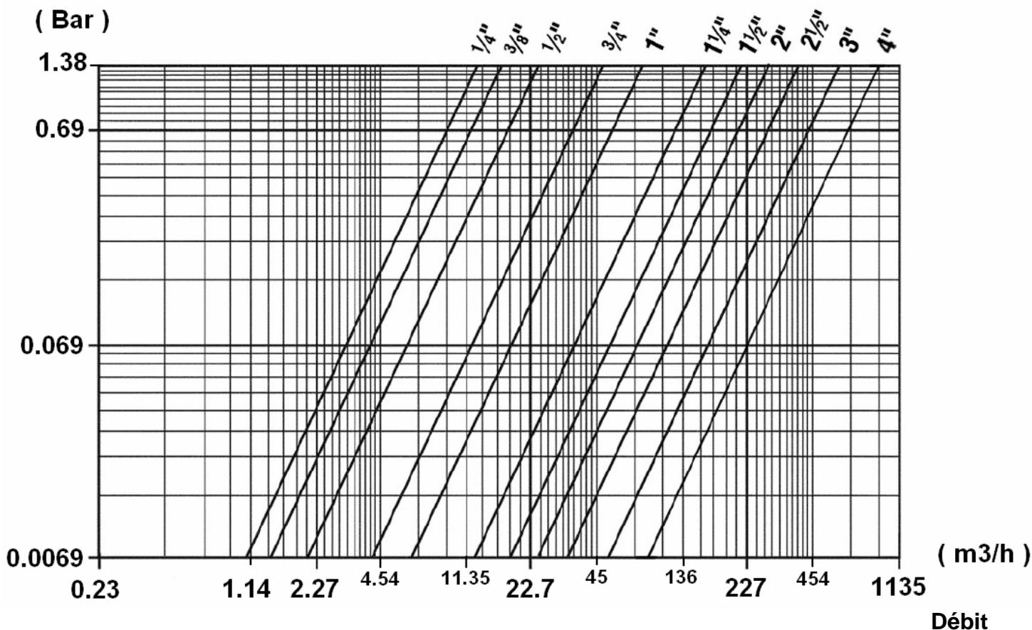
**VANNE A OPERCULE LAITON PN10/16**
