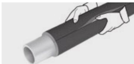
...finalement, collez les extrémités des isolants. Si on ne peut garantir la planéité des deux surfaces de jonction, il faut repasser sur celles-ci avec une brosse de colle pour apporter des corrections.
