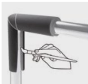
...finalement la pièce peut être mise sur la tuyauterie et collée.
