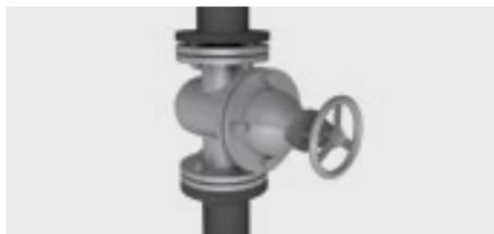
...déterminez à l'aide d'une bande INSUL ROLL la circonférence des brides et mesurez la distance «h». N'oubliez pas de déterminer la circonférence du corps de la vanne «D»...
