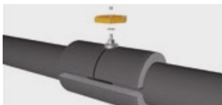
...finalement, collez les parties qui se chevauchent, ainsi que les découpes. Si nécessaire, un bout de manchon peut être utilisé pour isoler le bout de la tige de la vanne.
