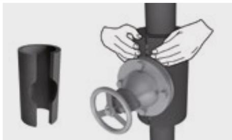
L'étape suivante consiste à isoler la crépine de la vanne. Il faut d'abord déterminer le diamètre de la bride ainsi que les dimensions de la crépine.
