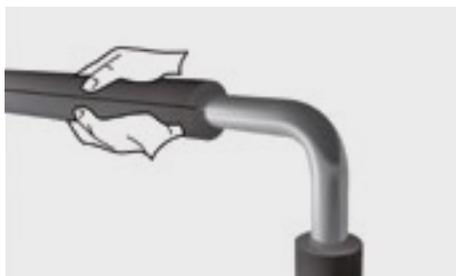
Poussez le manchon avec des mouvements circulaires sur le tuyau. Ne tirez pas et assurez-vous qu'il n'y a pas de superposition de l'isolation.
