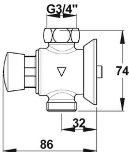
Avec 2 joints et écrous raccords 16x18 | Réf. 15000
