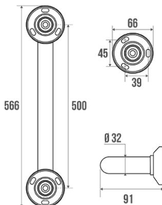
Tube laiton nickelé chromé Ø 32 mm.
