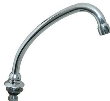
Livré avec écrou 1/2" (15x21) pour tube arrivée de 14 mm et joint fibre.
