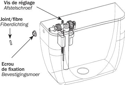
Schroef manueel de moer van het vlotterkraan vast tot ze in contact komt met het keramiek. Indien nodig schroeft u ze (maximaal) een bijkomende kwarts slag vast met de speciale sleutel.
