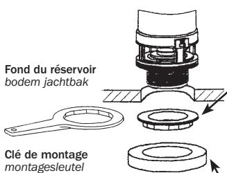
a - Visser à la main l'écrou de bonde (f) jusqu'au contact de la céramique. Si nécessaire visser d'un quart de tour supplémentaire (maxi) à l'aide de la clé spécifique.
