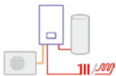
1 circuit chauffage radiateurs ou plancher chauffant + ballon ECS avec appoint électrique
