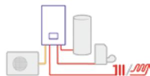
1 circuit chauffage radiateurs ou plancher chauffant + ballon ECS + chaudière fioul ou gaz pour la relève
