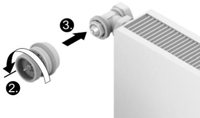
3. Tourner la molette de réglage de la tête de vanne jusqu'à la butée dans le sens contraire des aiguilles d'une montre.
