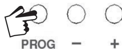
Utiliser les touches + et - pour régler l'heure (appuyer et tenir enfoncée l'une des touches pour changer l'heure par incréments de 10 minutes).
