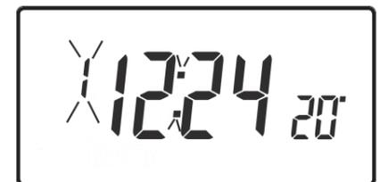
b) Appuyez sur les touches + et - pour régler l'heure (appuyer et tenir enfoncée l'une de ces deux touches pour régler l'heure par incréments de 10 minutes).
