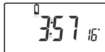
**IMPORTANT :** Après le remplacement des piles , appuyer sur le bouton reset à l'aide d'une pointe non métallique. Tous les réglages de date, d'heure, de programmation et de dérogation sont conservés pendant toute la durée de vie du thermostat.
