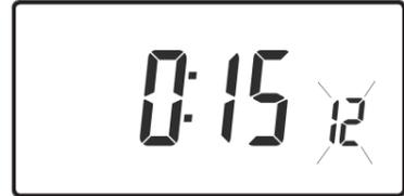
Le contrôle de démarrage optimal doit être réglé pour correspondre aux caractéristiques énergétiques du bâtiment. Appuyez sur les touches **Λ** et **V** pour sélectionner la période de préchauffage requise. Le tableau ci-dessous propose des réglages types. Si la température du bâtiment n'atteint pas la valeur sélectionnée dans le délai imparti, il faut augmenter le réglage par incréments de 15 minutes tous les jours jusqu'à ce que le réglage correct soit atteint.
