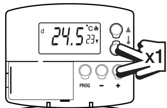
**Etape 2** Appuyer et maintenir enfoncées les touches **V** et **+** pendant 3 secondes (le TP5001 RF Si émet alors un signal unique en continu pendant 3 minutes)
