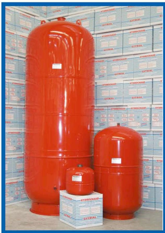
Les vases fermés GITRAL® à membrane fixe sont destinés aux installations de chauffage fonctionnant en circuit fermé. Ils permettent d'absorber les augmentations de volume consécutives à l'élévation de température du fluide chauffant du circuit fermé. La température de fonctionnement est comprise entre 0 et 99° C.
